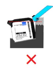
⑦本体を押さえながらレバーを奥の方まで倒して、ヘッドを下にしてインクカートリッジを下図のようにできるだけ立てた状態でゆっくりインクカートリッジホルダーの奥まで差し込んでください。
