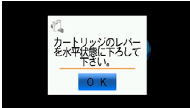
⑨インクカートリッジの先端のフックとレバーの下端が引っ掛かるようにして、レバーを水平状態に下ろしてください。
