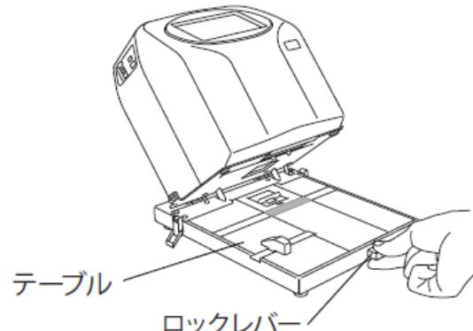
⑥印刷対象物を挿入し、印刷範囲を示す罫線を目印に幅方向の位置決めレバーを移動させて印刷対象物の幅方向の位置決めを行ってください。
