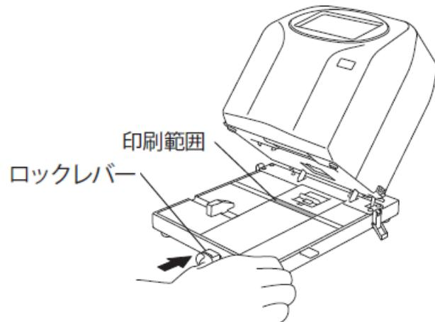
⑧印刷対象物を挿入して、印刷範囲を示す罫線を目印に長手方向の回転ツマミを回して位置決めプレートを移動させて、印刷対象物の長手方向の位置決めを行ってください。
